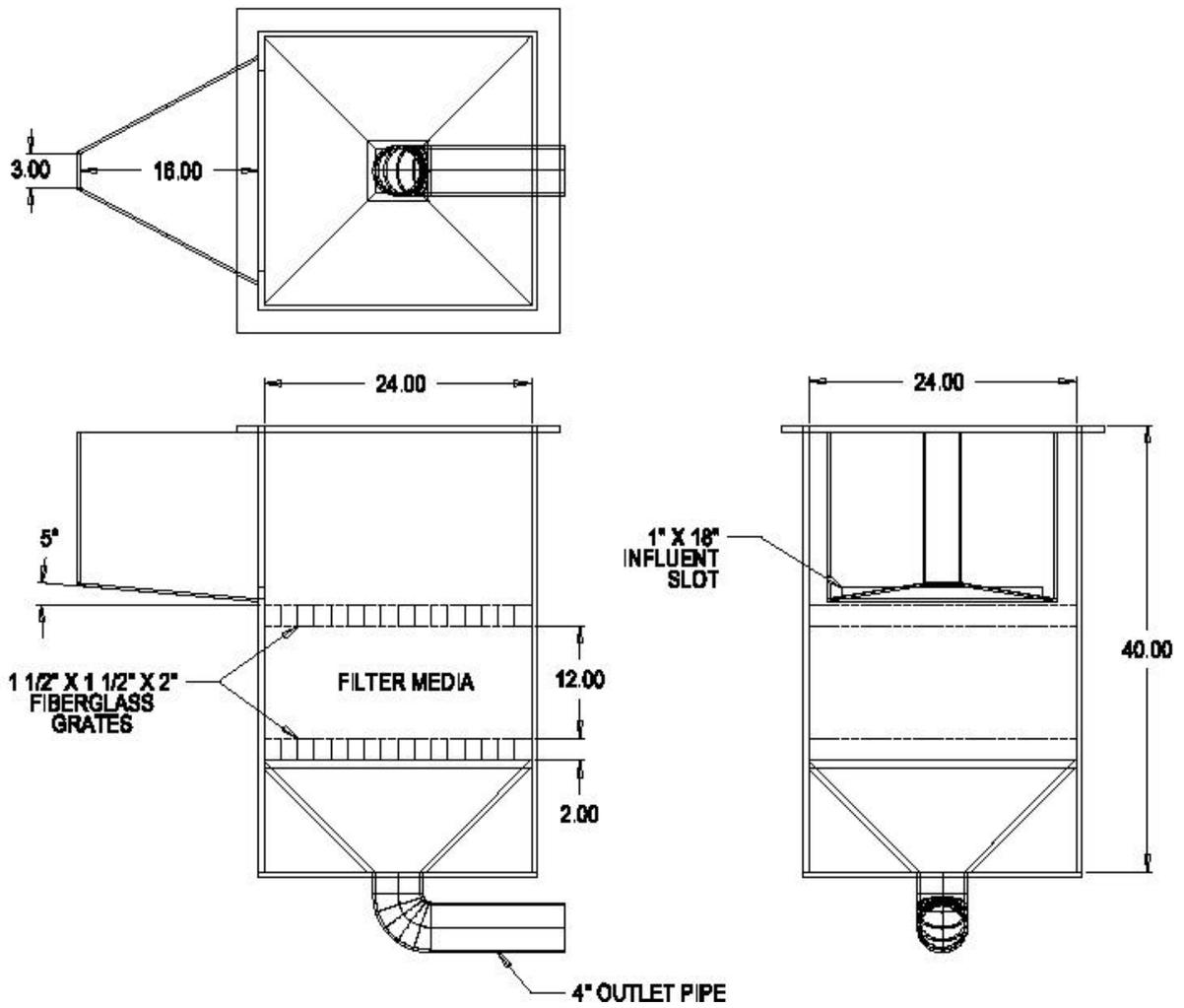
Figure 2: Aqua-Filter Test Tank
